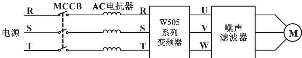
图 4-1-3 主回路电机侧连接图
