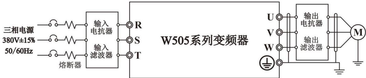
图 4-2-11 主回路接线图 (380V)
