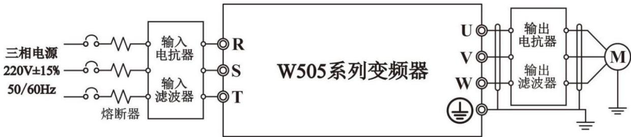
图 4-2-5 主回路接线图 (220V)
